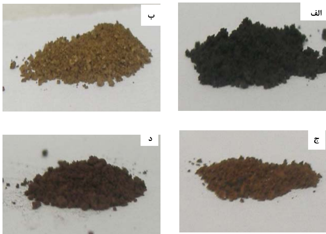
شکل ۳: تصاویری از پودرهای تهیه شده، الف) ۳۰۰ °C (MnO 2 )، ب) ۶۰۰ °C (Mn 2 O 3 )، ج) ۸۰۰ °C (ترکیبی از دو فاز Mn 2 O 3 و Mn 3 O 4 ) و د) ۱۰۰۰ °C (Mn 3 O 4 ).
