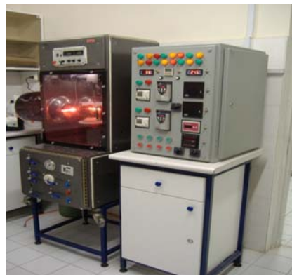
شکل ۱: دستگاه پوشش دهنده غوطه‌وری - چرخشی واقع در دانشگاه گیلان.
